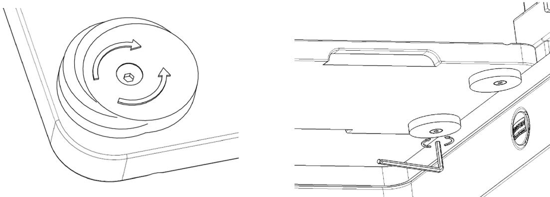
4. -Schrauben leicht anziehen um ein Verrücken des ersten Fusses beim Einstellen des zweiten Fusses zu verhindern.
