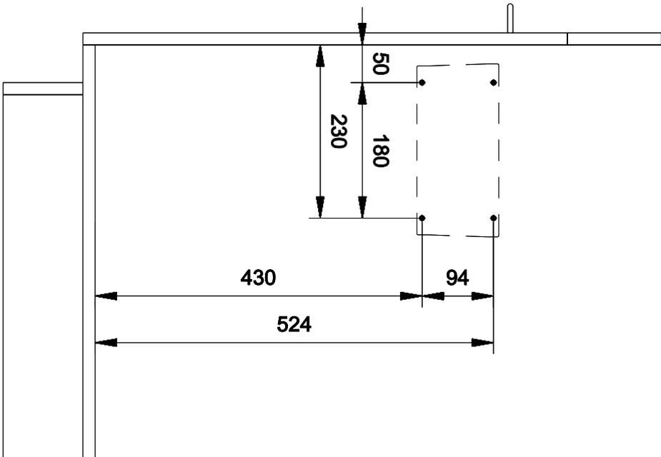
Bohrbilder: Front / Kastenboden / Seitenwand L+R
