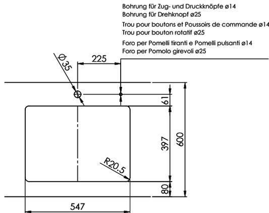
Bohrung für Zug- und Druckknöpfe ø14
