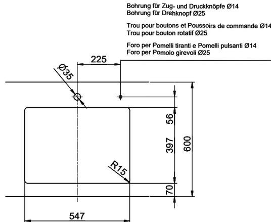
Bohrung für Zug- und Druckknöpfe Ø14
