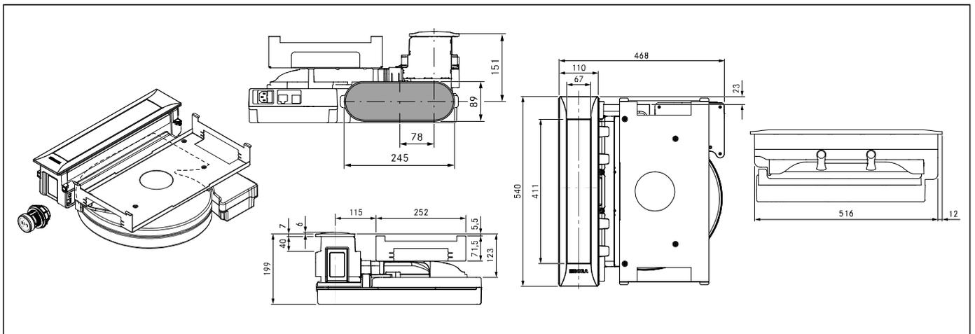
**Planungshinweis:** Bei diesen Geräten ist der Kanalanschluss auf das BORA Ecotube Kanalsystem ausgelegt. Um BORA Ecotube (Anschluss 245 × 89 mm) mit Naber-Anschlüssen (222 × 89 mm) zu verbinden, ist ein Adapter (EFA, 40.001.779, CHF 28.–, exkl. MwSt., siehe Seite 376) verfügbar/separat bestellbar.
