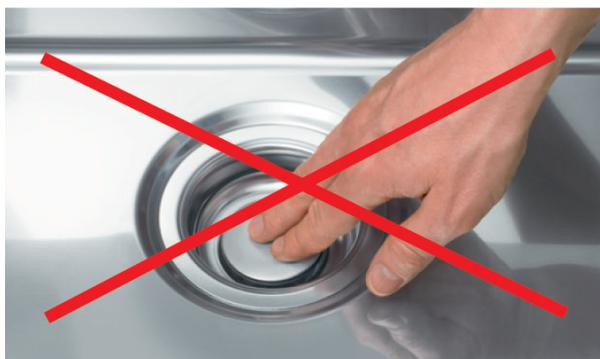
La valvola Touch Flow non richiede alcuna manutenzione particolare. Essa dev'essere sempre azionata mediante la piastra di troppopieno. In nessun caso si dovrà chiudere lo spintore manualmente: ciò potrebbe danneggiare il motore o causare il bloccaggio dello spintore all'interno della valvola.
