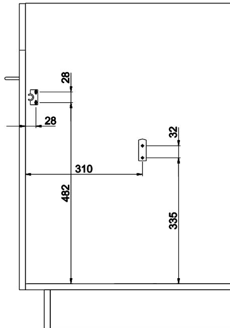
Bohrbilder: Front / Kastenboden / Seitenwand L+R
