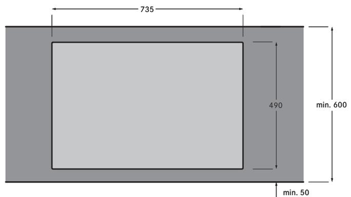
Bezüglich der Eignung der Arbeitsplatte müssen die Hinweise der Arbeitsplatten-Hersteller eingehalten werden. So sind z. B. Arbeitsplatten-Ausschnitte mit geeigneten Mitteln gegen Feuchtigkeit zu versiegeln.
